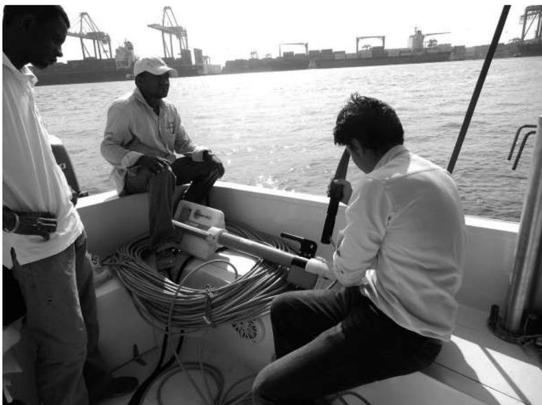
Figura 2. Magnetómetro de vapor de Cesio Geometrics G-882, utilizado para la detección de anomalías magnéticas (Juan G. Martín).
