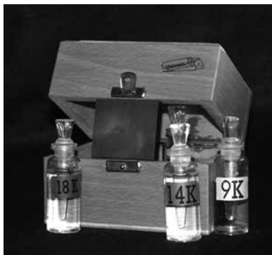
Figura 3. Equipo portátil con químicos y piedra de toque para el examen de objetos de oro. Fuente: https://es.wikipedia.org/wiki/Piedra_de_toque
